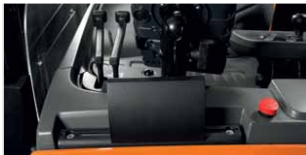
Le support universel E-bar permet de raccorder des équipements de gestion d'entrepôt tels qu'ordinateurs, périphériques informatiques et lecteurs de codes barres
