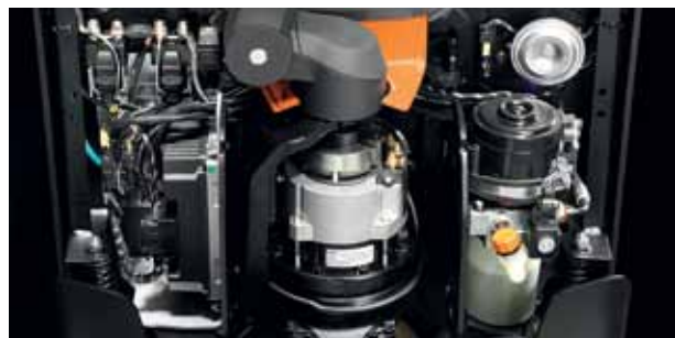
Le moteur fixe ne présente pas de câbles en rotation
