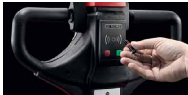
L'accès intelligent « Smart access » via une clé ou carte de commande à distance garantit que le chariot démarre avec les réglages de performance appropriés pour chaque opérateur
