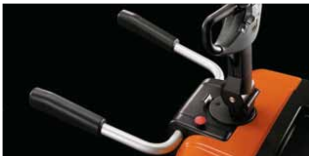
Les protections latérales rabattables protègent l'opérateur, sans pour autant affecter la maniabilité offerte par la plateforme rabattable
