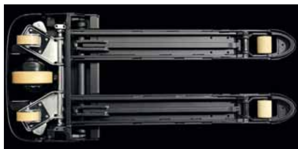
Le châssis 5 roues unique améliore la stabilité sur rampes
