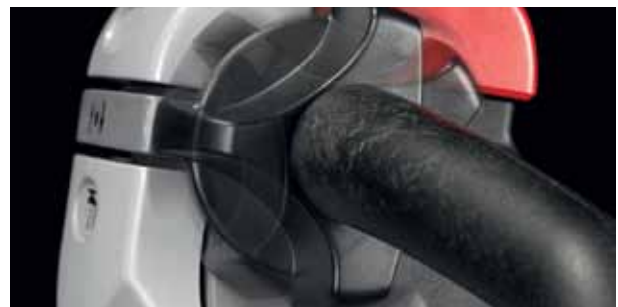
Avec la fonction Click-2-Creep (ou vitesse d'approche par double clics), le chariot se dirige avec la poignée en position verticale
