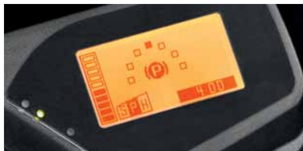
L'indicateur de direction indique en temps réel au cariste le positionnement des roues directrices
