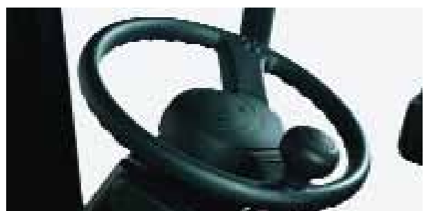
Le volant compact du Traigo HT facilite les manoeuvres. Le synchroniseur actif de direction contribue également à une position de conduite confortable
