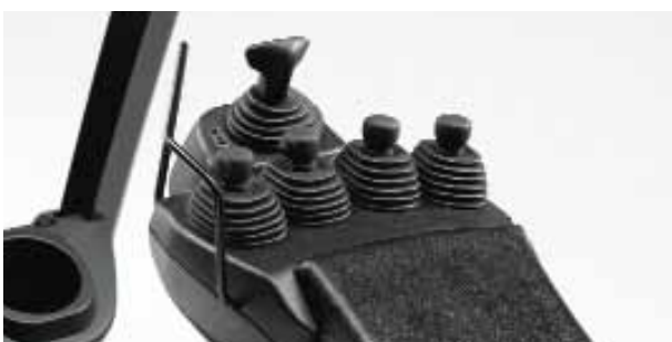
Les minileviers réglables assurent la commande du bout des doigts et sont intégrés dans l'accoudoir ergonomique (de série sur le Traigo HT)
